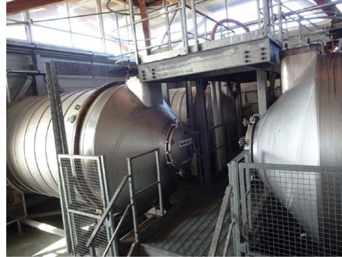
タンクはこんな風にぎっしり並ぶ。クローズドタンクはヘッドスペースを減らすために煙突状の出っ張りのあるタイプ。水平方向だけでなく、上下方向にも無駄な隙間なく並べられる。タンクなどの設備配置と建物設計がインテグレートされているのが分かる。
