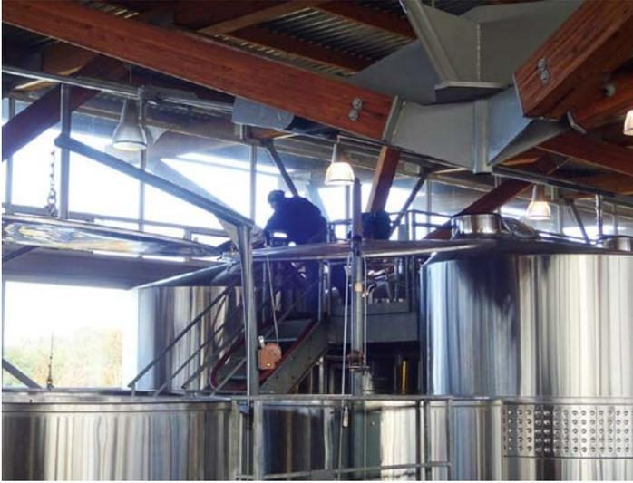
これはタンクに向かう配管の一つ、「Low Pressure Nitrogen 低圧窒素」とある。酸化防止にタンクのヘッドスペースなどに使用。窒素利用はごく一般的。
